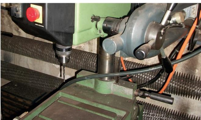
**Flott pneumatische Vorschubbohrmaschine**
